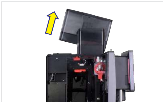
2. コーヒー豆ホッパーとパウダーホッパーを持ち上げて取り外します。
